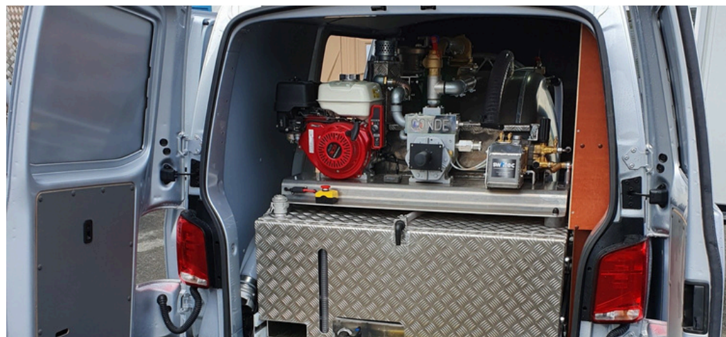
Véhicule hydrocureur de nettoyage pour une société de curage de réseaux
